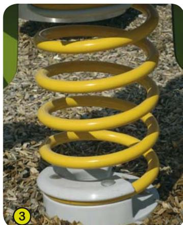
3- **El muelle** es de acero 35SCD6. La superficie del muelle se trata después con granalla pretensada con capas de preparación de zinc y 2 capas de polvo de poliéster de 100 micrones. La pieza de fijación (Patente Proludic) en poliamida cargada garantiza una longevidad y una seguridad excepcional al sistema.
