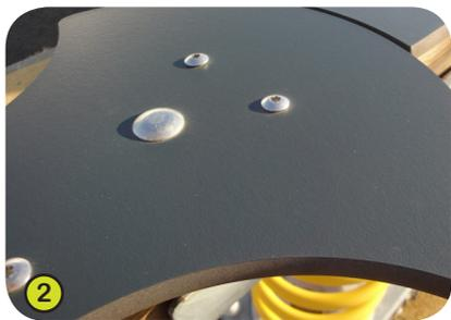
2- **Los asientos** se fabrican con HPL (Laminado Alta Presión) de 13 mm de espesor. Compuesto en un 70% de fibras de madera blanda y un 30% de resina termoendurecible, presenta una excelente resistencia contra las inclemencias del tiempo.
