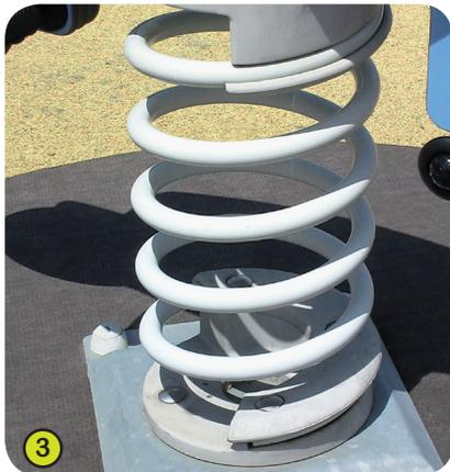
3- **Los muelles** son de acero 35SCD6. La superficie del muelle se trata después con granalla pretensada con capas de preparación de zinc y 2 capas de polvo de poliéster de 100 micrones. La pieza de fijación (Patente Proludic) en poliamida cargada garantiza una longevidad y una seguridad excepcional al sistema.
