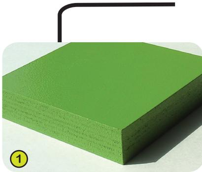
1- **Los paneles lacados** se elaboran a partir de un contrachapado alta calidad de 22 mm de grosor, compuesto de láminas alternas de abedul. La coloración mediante pulverización electrostática de laca de poliuretano de doble componente sin materiales pesados garantiza una gran resistencia a las potenciales agresiones químicas, como productos de mantenimiento anti-grafiti.
