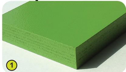
1- **Los paneles lacados** se elaboran a partir de un contrachapado alta calidad de 22 mm de grosor, compuesto de láminas alternas de abedul. La coloración mediante pulverización electrostática de laca de poliuretano de doble componente sin materiales pesados garantiza una gran resistencia a las potenciales agresiones químicas, como productos de mantenimiento anti-grafiti.
