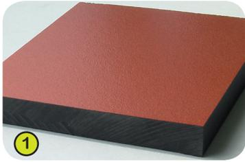
1- **Los tableros** se fabrican con HPL (Laminado Alta Presión) de 13 mm de espesor. Compuesto en un 70% de fibras de madera blanda y un 30% de resina termoendurecible, presenta una excelente resistencia contra las inclemencias del tiempo (sol, lluvia, humedad...). Los paneles de color se tratan a base de resinas acrílicas de poliuretanos pigmentados, lo que le garantiza una buena resistencia contra los rayos UV y las degradaciones.
