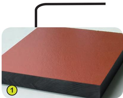
1- **Los tableros** se fabrican con HPL (Laminado Alta Presión) de 13 mm de espesor. Compuesto en un 70% de fibras de madera blanda y un 30% de resina termoendurecible, presenta una excelente resistencia contra las inclemencias del tiempo (sol, lluvia, humedad...). Los paneles de color se tratan a base de resinas acrílicas de poliuretanos pigmentados, lo que le garantiza una buena resistencia contra los rayos UV y las degradaciones.
