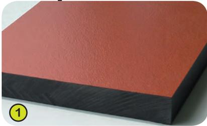
1- **Los tableros** se fabrican con HPL (Laminado Alta Presión) de 13 mm de espesor. Compuesto en un 70% de fibras de madera blanda y un 30% de resina termoendurecible, presenta una excelente resistencia contra las inclemencias del tiempo (sol, lluvia, humedad...). Los paneles de color se tratan a base de resinas acrílicas de poliuretanos pigmentados, lo que le garantiza una buena resistencia contra los rayos UV y las degradaciones.
