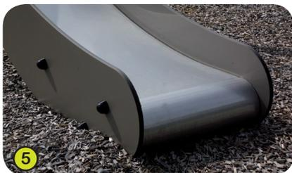
5- **La superficie deslizante del tobogán** es de acero inoxidable de 2 mm de espesor, curvados, ondulados y moldeados en una sola pieza.
