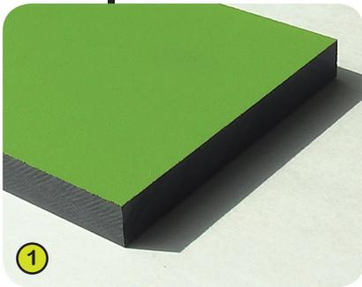
**1- Los tableros** se fabrican con HPL (Laminado Alta Presión) de 13 mm de espesor. Compuesto en un 70% de fibras de madera blanda y un 30% de resina termoendurecible, presenta una excelente resistencia contra las inclemencias del tiempo (sol, lluvia, humedad...). Los paneles de color se tratan a base de resinas acrílicas de poliuretanos pigmentados, lo que le garantiza una buena resistencia contra los rayos UV y las degradaciones.
