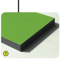
1- Los tableros se fabrican con HPL (Laminado Alta Presión) de 13 mm de espesor. Compuesto en un 70% de fibras de madera blanda y un 30% de resina termoendurecible, presenta una excelente resistencia contra las inclemencias del tiempo (sol, lluvia, humedad...). Los paneles de color se tratan a base de resinas acrílicas de poliuretanos pigmentados, lo que le garantiza una buena resistencia contra los rayos UV y las degradaciones.
