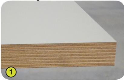
1- **Los paneles lacados** se elaboran a partir de un contrachapado de alta calidad de 22 mm de grosor, compuesto de láminas alternas de abedul. Las imágenes personalizadas se imprimen directamente en los paneles, y posteriormente se protegen mediante una capa de barniz altamente resistente.
