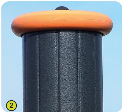
2- **Los postes** son de acero galvanizado lacado, de 125 mm de diámetro. El acabado con apariencia de granito en dos tonos de gris, presenta ligeros relieves y confiere una mejor resistencia a las ralladuras. **Los cabezales** son de poliamida inyectada.
