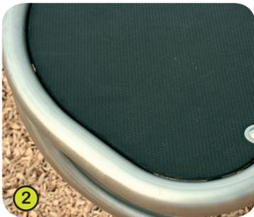
2- Los suelos «Durax» se elaboran con paneles de contrachapado de alta calidad, de 22 mm de espesor compuestos de láminas de abedul. La superficie se recubre de una película de resina de poliolefina termoplástica de relieve antideslizante, y se rodean con un tubo de acero inoxidable de 40 mm de diámetro.
