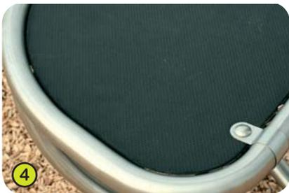
4- Los suelos «Durax» se elaboran con paneles de contrachapado de alta calidad, de 22 mm de espesor compuestos de láminas de abedul. La superficie se recubre de una película de resina de poliolefina termoplástica de relieve antideslizante, y se rodean con un tubo de acero inoxidable de 40 mm de diámetro.
