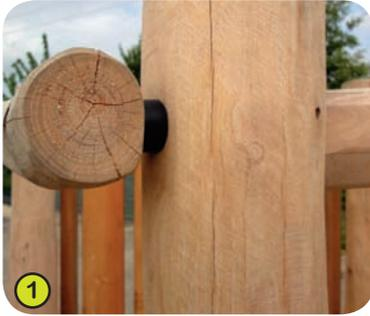
1- **Los diferentes postes** (60 a 80 mm/ 100 a 120 mm/ 120 a 140mm), **y los escalones** (con diámetros entre 330 y 350mm) están hechos de madera de robinia sin albura. La robinia está lijada y se elimina la corteza. La robinia en su estado natural no se pudre y no necesita protección química; es extremadamente resistente a agentes externos (insectos, hongos, variaciones climáticas), garantizando la durabilidad de los juegos a lo largo de los años.
